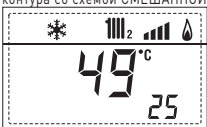
26. Визуализация предохранительного термостата со схемой СМЕШАННОЙ ЗОНЫ 2 (вход S1) соответственно ВКЛ. и ВЫКЛ.
